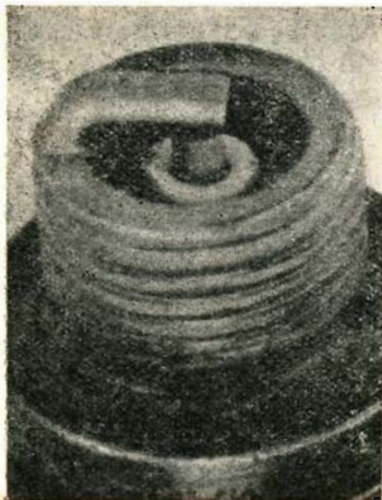
Fig. 10 - Ogni 4000 chilometri di marcia sottoporremo a pulizia la candela a mezzo forte gettito di sabbia. A pulizia avvenuta controlleremo lo stato dell'isolante, che non dovrà presentare screpolature per non infirmare il buon funzionamento del motore.
