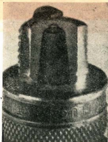
Fig. 5 - Nell'eventualità di depositi di color nerastro dedurremo come la candela non risulti del giusto grado termico (praticamente si dirà che la candela risulta troppo « fredda ») e quindi provvederemo alla sua sostituzione con altra più « calda »). L'inconveniente dei depositi nerastri potrà altresì venir imputata al gicleur, di numero superiore al necessario, il quale determina un abbondante afflusso di miscela.
