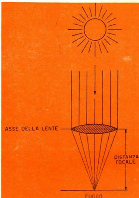
Fig. 2 - Metodo di rintraccio distanza focale per lenti positive.
